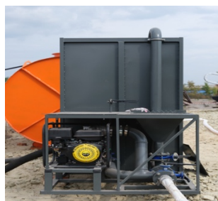
Рисунок 2-28 Устройство для смешивания бурового раствора
